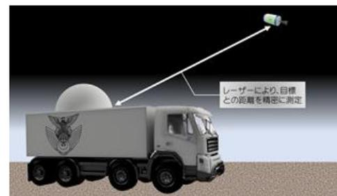
SSAレーザー測距装置 (イメージ)
