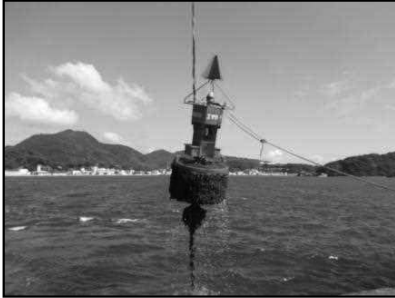
灯浮標の引揚げ
