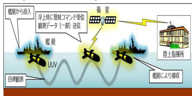
U U V (水温構造等観測用)(供試器材)の性能試験
